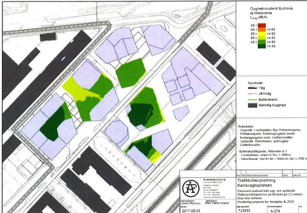
Bullersituationen för de större takterrasserna
